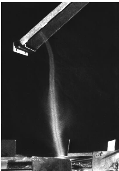
Рис. 2.5. Сжатие газового вихря на входе в воздухозаборник (слева сверху) реактивного двигателя самолета на стоянке
